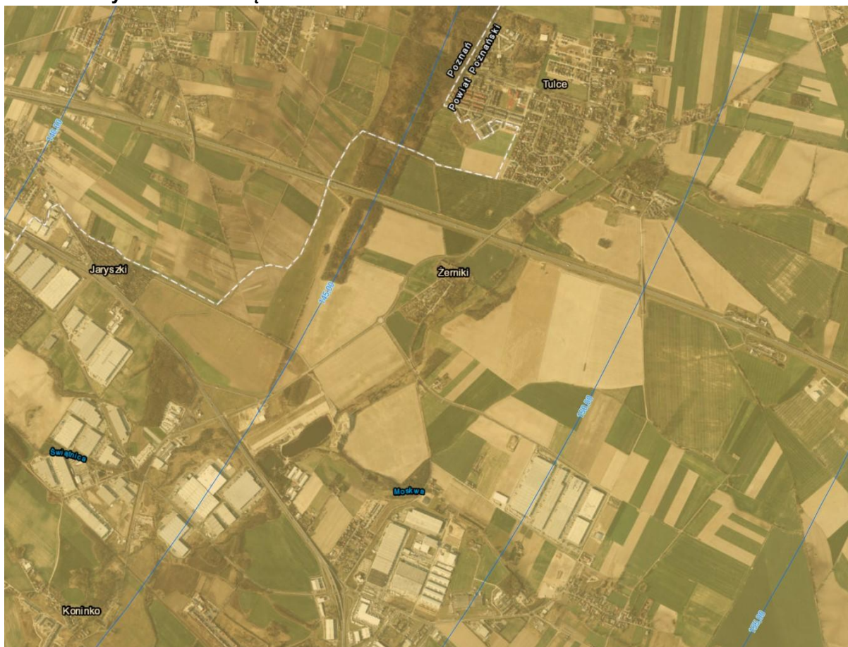
Ryc. 24 Lokalizacja strefy powierzchni ograniczającej zabudowę (BRA) dla lotniczych urządzeń naziemnych (LUN) nakaz ograniczenia wysokości obiektów budowlanych wraz z umieszczonymi na nich urządzeniami
