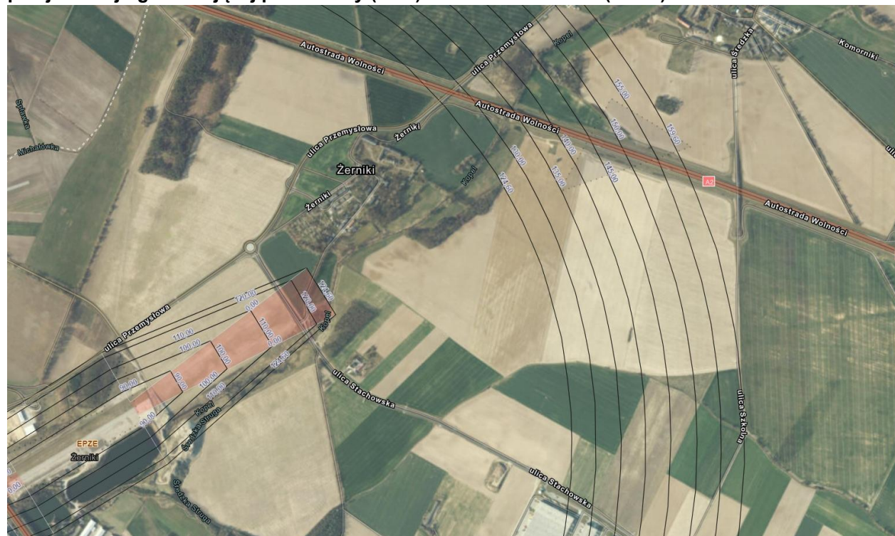
Ryc. 23 Strefy powierzchni podejścia ograniczającej przeszkody (OLS) oraz strefy powierzchni przejściowej ograniczającej przeszkody (OLS) dla lotniska Żerniki (EPZE)
