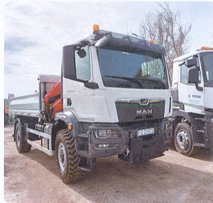
Samochód ciężarowy typu wywrotka z żurawiem przenośnym HDS, posypywarką i pługiem odśnieżnym
